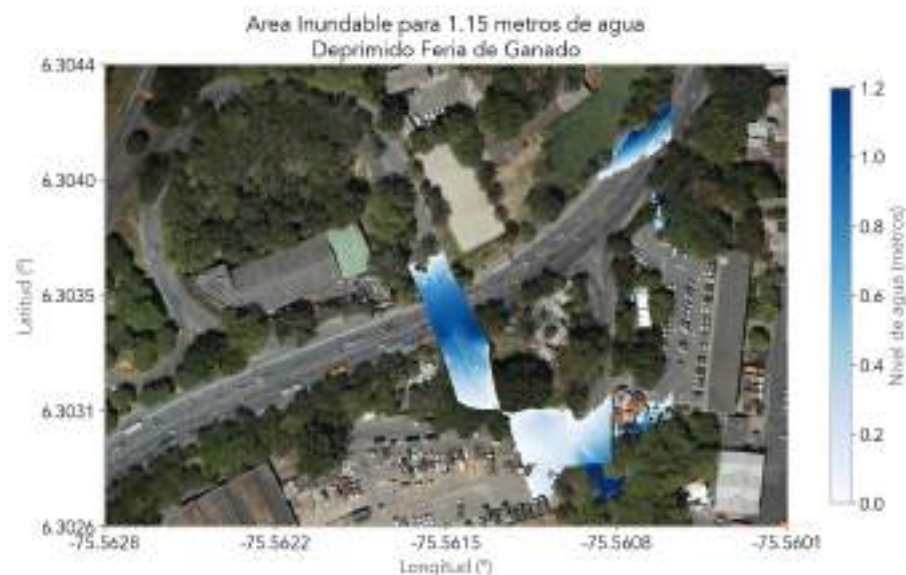
Figura 9.2: Análisis de área inundable con sobrevuelo VANTs sobre deprimido Feria de Ganado.
