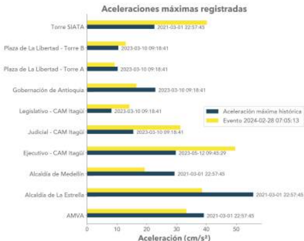
Figura 7.4: Resumen de aceleraciones máximas registradas por la red de monitoreo estructural durante los sismos más relevantes del mes de febrero de 2024, comparadas con las máximas históricas registradas en cada edificio. Las fechas (hora UTC) frente a cada barra están asociadas al sismo que produjo cada máximo histórico. El sismo del 28 de febrero generó aceleraciones máximas históricas en cinco (5) edificios de la red de monitoreo estructural.
