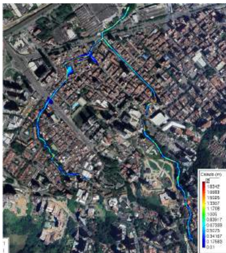
Figura 7.2: Área de inundación de las quebradas La Doctora y La Sabanetica.
