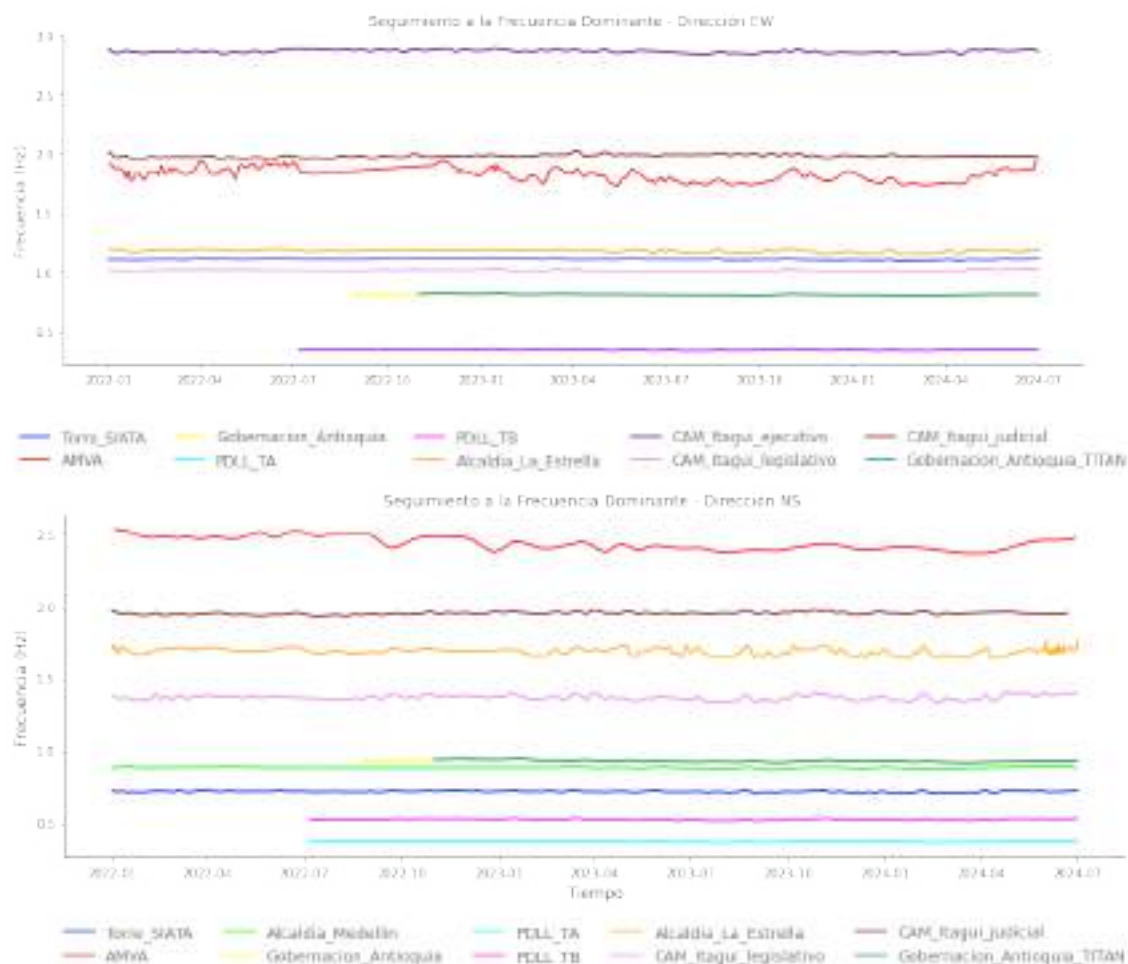
Figura 8.5: Consolidado del seguimiento a las frecuencias dominantes en dirección traslacional EW (superior) y NS (inferior) para todos los edificios que integran la red de monitoreo estructural. Mediciones entre el 1 de enero de 2022 y el 31 de julio de 2024.
