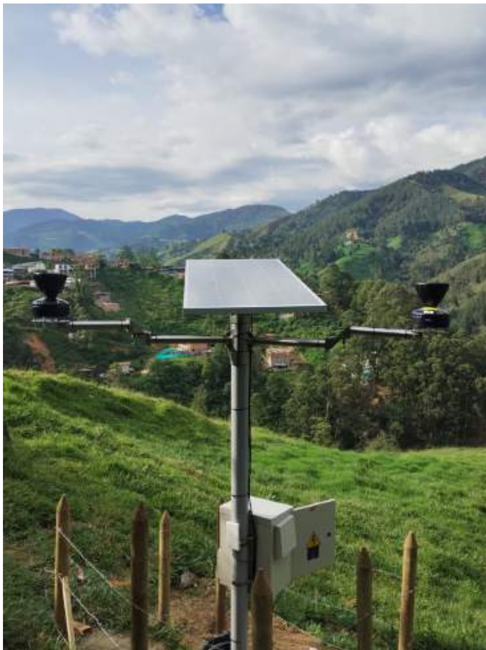
Figura 18.12: Lomita Parte Baja - Pluviómetro.
