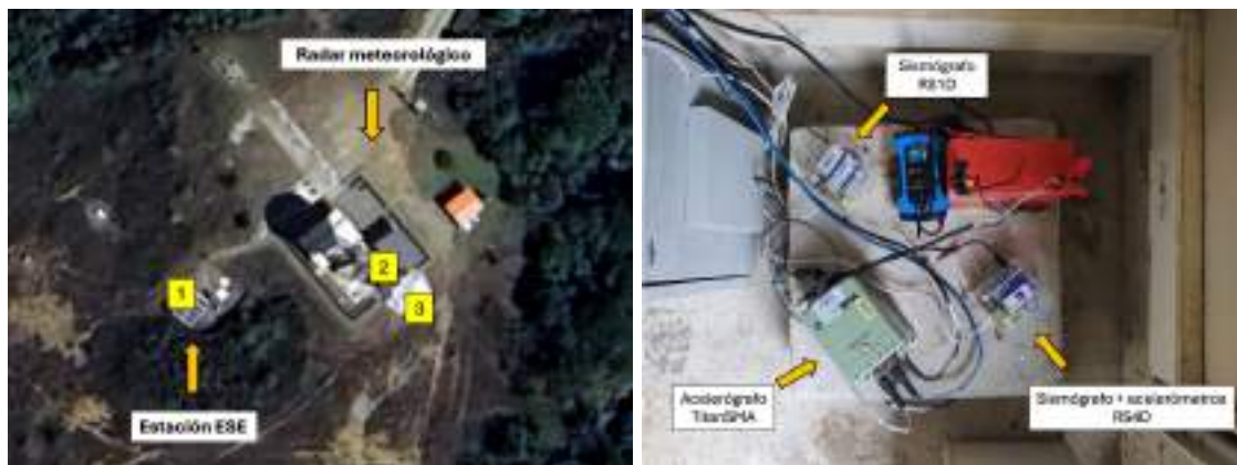
Figura 11.12: Izquierda: localización de los lugares de medición para las pruebas realizadas con el sensor RS4D en la estación Santa Elena (ESE). Derecha: instalación temporal del sensor RS4D para realizar comparaciones con el acelerógrafo TitanSMA.
