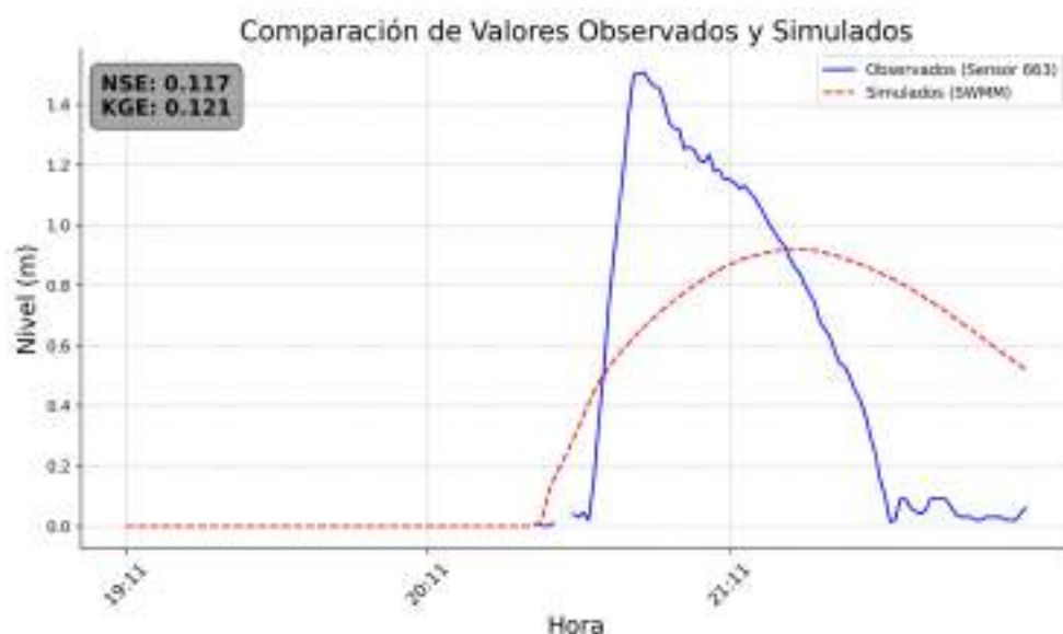
Figura 8.4: Comparación de los niveles simulados y observados en la vía para el evento del 2 de octubre de 2023.
