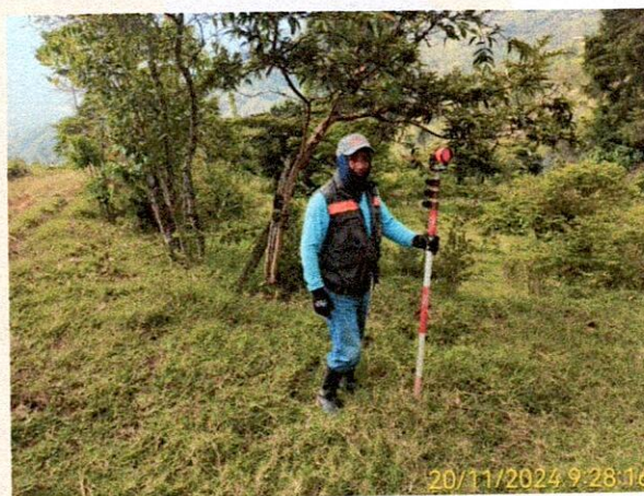
Fotografía: Levantamiento topográfico para el trazado de la red de conducción entre el desarenador y la planta de tratamiento de agua potable.
