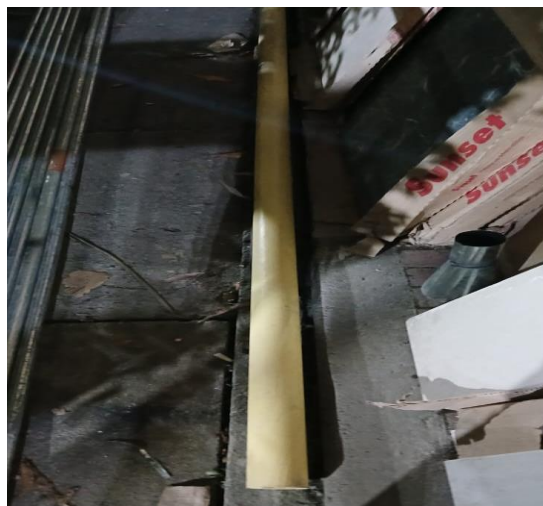
Tubería PVC Sanitaria 2"
