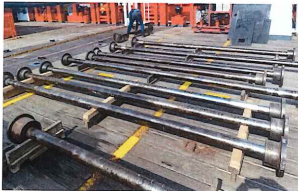
Imagen No. 21: Aplicación de capa de aceite a 12 secciones de ejes para evitar corrosión.
