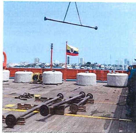
Imagen No. 22: Embarque secciones de ejes posterior a verificación de deflexión.
