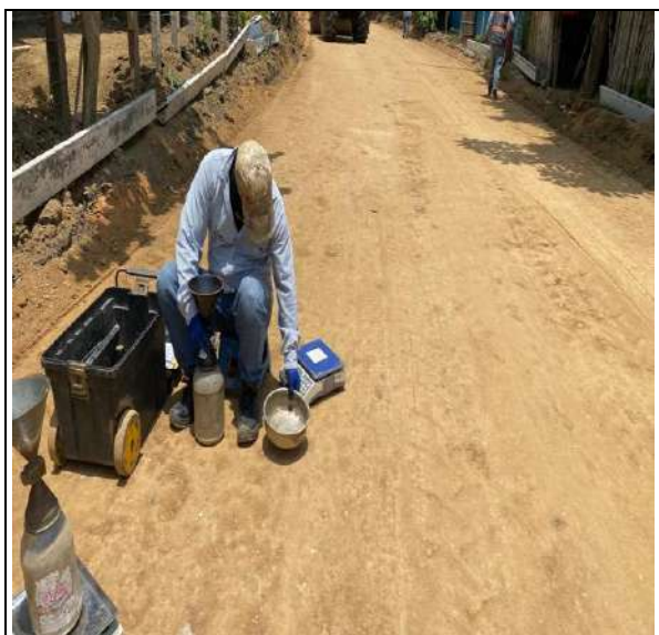
FOTO No. 41 Toma de densidades a capa sub base granular tramo T4 entre absc K0+75.19 la K0+000
