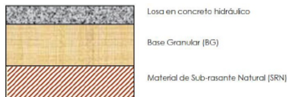
Figura 5 - 2 Esquemas de estructuras utilizadas en el diseño con concreto con método Inviás
