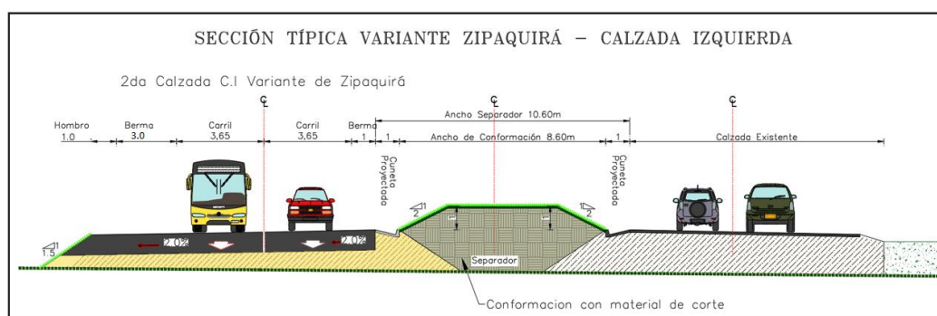
Ilustración No 4. Sección típica de la vía
