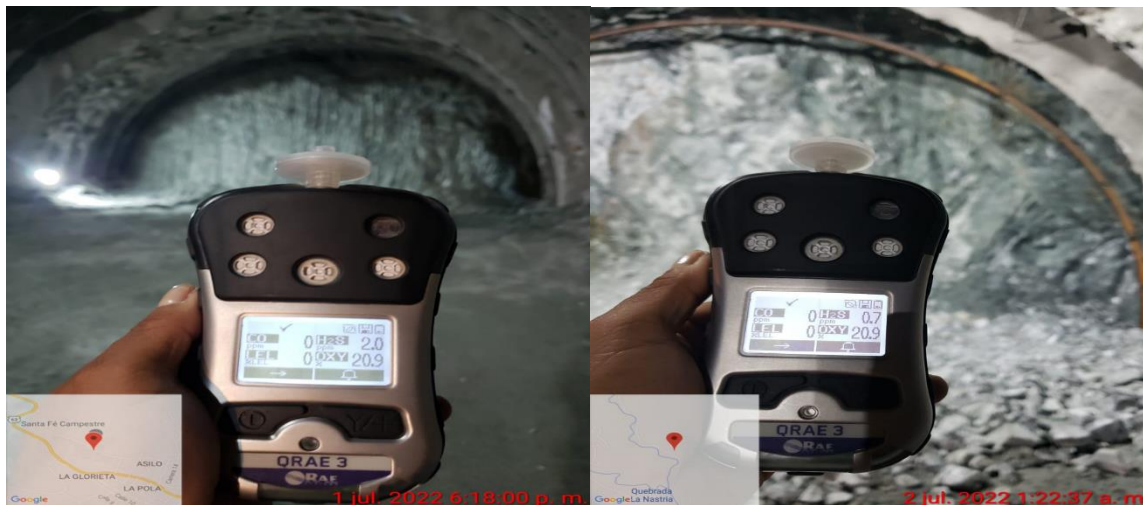
Foto: toma de medidas de gases en túneles 3y 4
