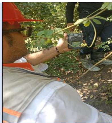
Foto 3-33 Tunel 3, Medicion de gases, parte superior portal entrada tunel-
