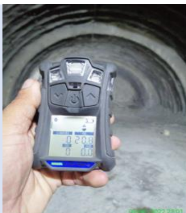
Foto 3-32 Túnel 3, Medición de gases.
