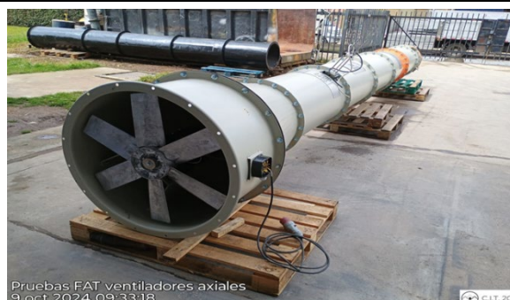
Fotografía No. 8 – Pruebas FAT Ventiladores Axiales - 9 de octubre de 2024.
