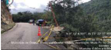
Toma de muestra de geotecnia ensayo de Penetración Estandar PR 10+500 vía Ocaña límites Morrison
