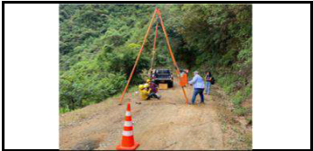
Toma de muestra de geotecnia ensayo de Penetración Estandar PR 15+200 vía Ocaña límites Morrison
