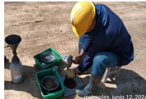
Toma de densidades de Terreno para chequeo de grado de compactación
