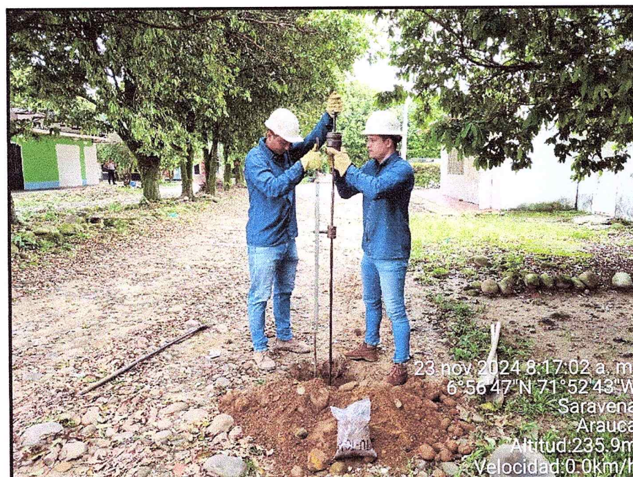
Foto 2. Ensayo de Penetración Dinámica de Cono (PCD), Apique A-01
