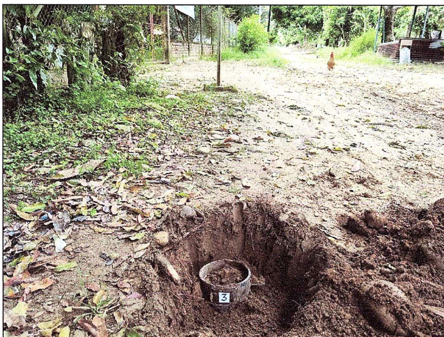
Foto 9. Toma de muestra en molde CBR, Apique A-03
