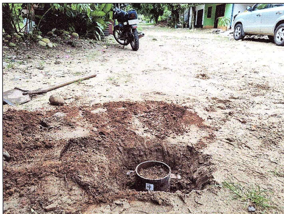
Foto 12. Toma de muestra en molde CBR, Apique A-04
