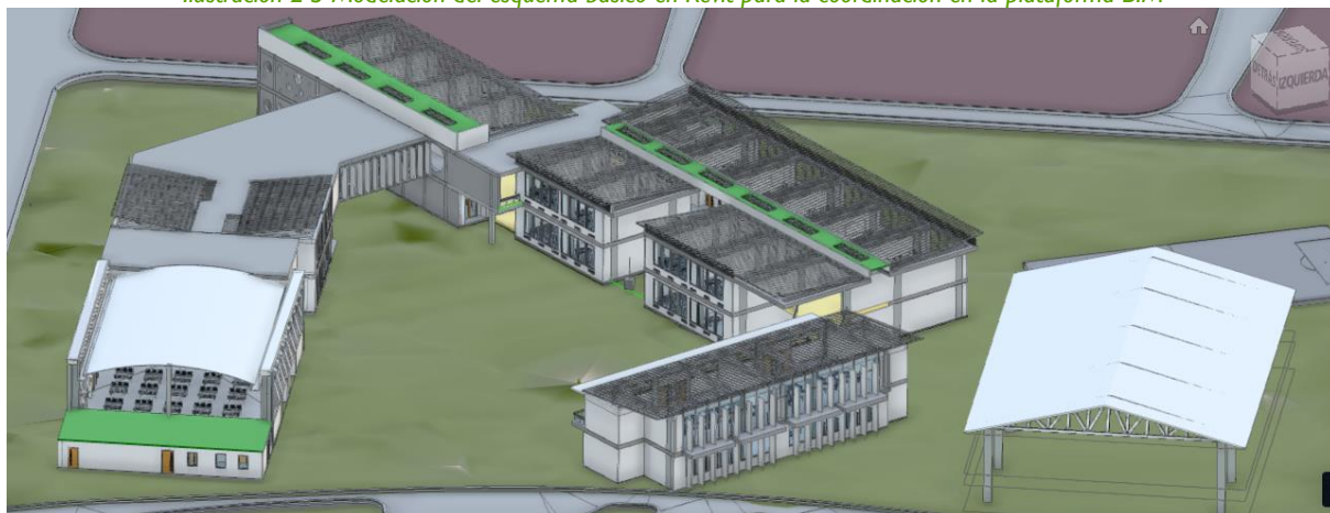
Ilustración 2-3 Modelación del esquema básico en Revit para la coordinación en la plataforma BIM
