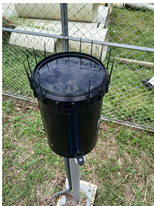
Figura 10. Pluviómetro encontrado tapado antes del mantenimiento.
