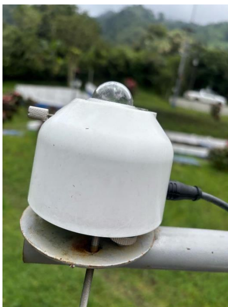
Figura 18. Piranómetro MS-40S después del mantenimiento.
