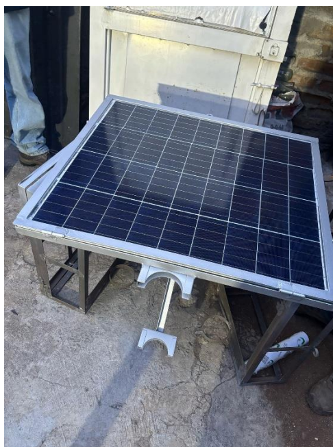
Figura 14. Base a la medida del panel solar nuevo para instalación en la estación.
