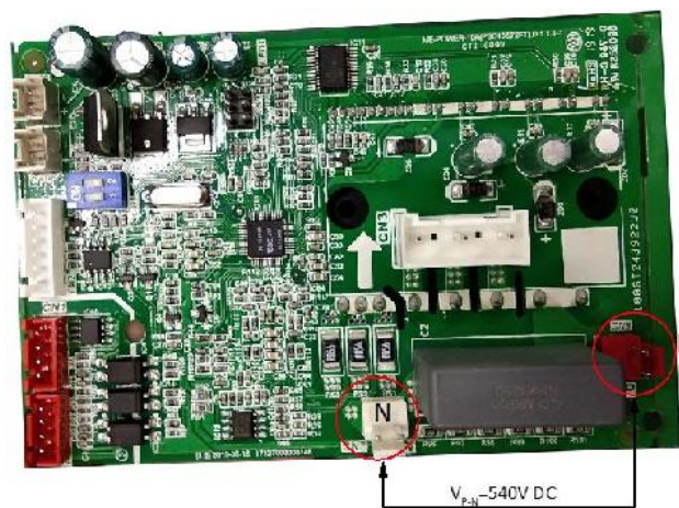
Figure: Fan module P N terminals
