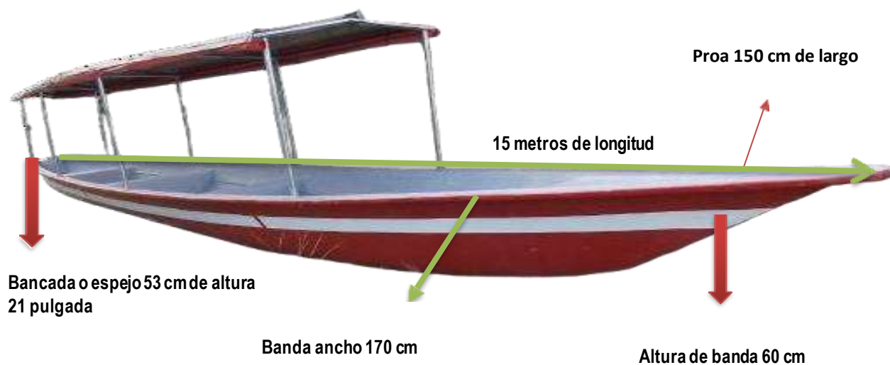
Disposición General – Vista de perfil. Referencia de canoas fabricadas por la empresa
