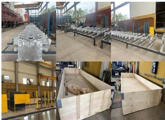
Foto No. 15 a 20 – construcción y alineación de cunas y guacales
