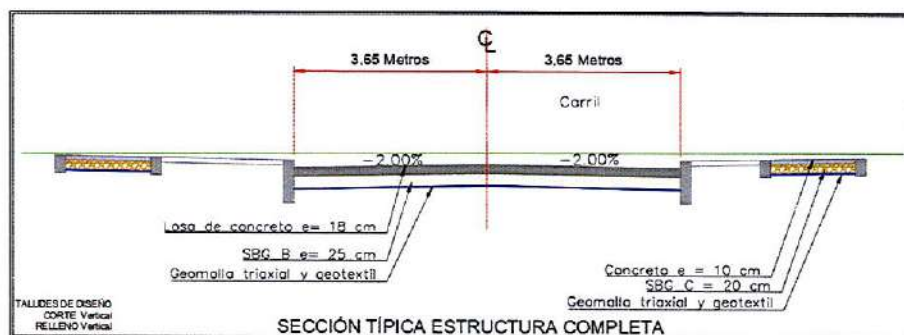
IMAGEN 5. ESTRUCTURA DEL PAVIMENTO.
