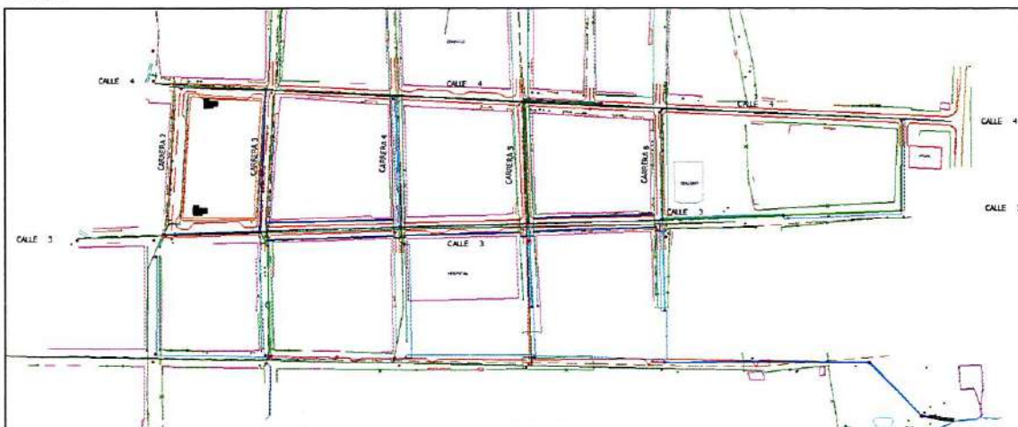
IMAGEN 2. RED ALCANTARILLADO PLUVIAL.
