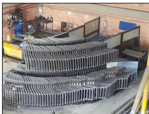
Imagen 12. Terminación de soldadura de bases CP-1, sin pintar.
