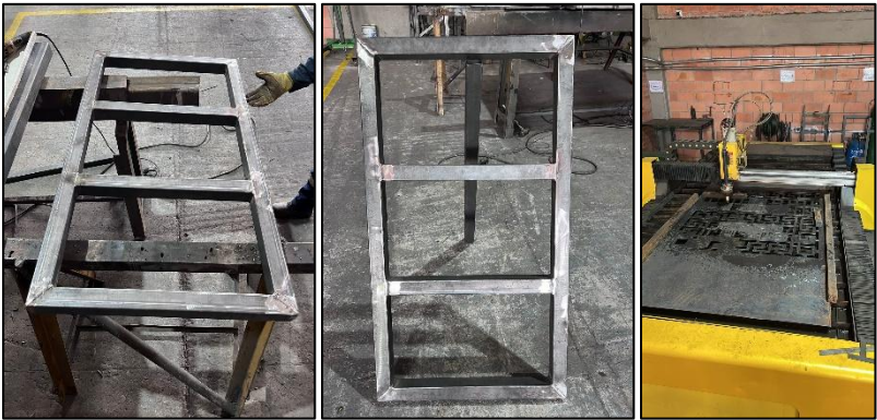
Imagen 1. Fabricación de modulo prototipo CP-1 y CP-2.
