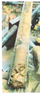
Locación área sondeo P-1 (K7+250). Recuperación de materiales que conforman la matriz de arena. Alta presencia de cantos y bloques de arenisca.
