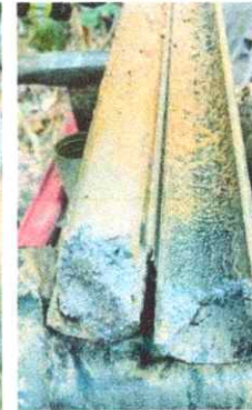
Locación área sondeo P-2 (K7+270). Recuperación de muestras por ensayo de penetración estándar (SPT) a profundidades de 0.6 – 1.2 m, 1.2 – 1.8 m y 1.8 – 2.4 m (rechazo de SPT a 2.55 m).
