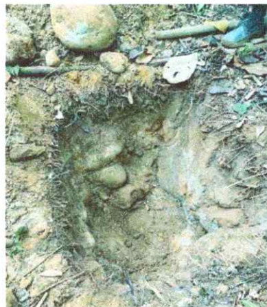
Locación área sondeo P-1 (K7+250). Recuperación de materiales que conforman la matriz de arena. Alta presencia de cantos y bloques de arenisca.
