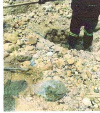
Rechazo de excavación manual y recolección de muestras de matriz arenosa
