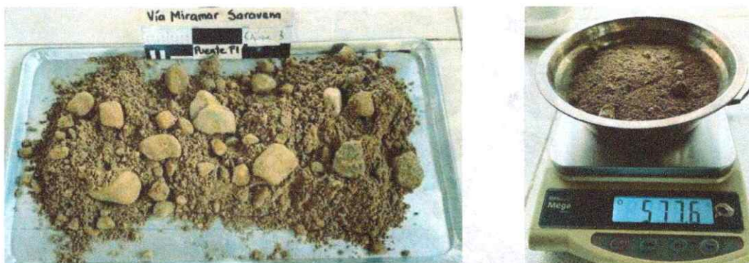
Fotografía 7. Preparación de muestras para humedad natural y gradación
