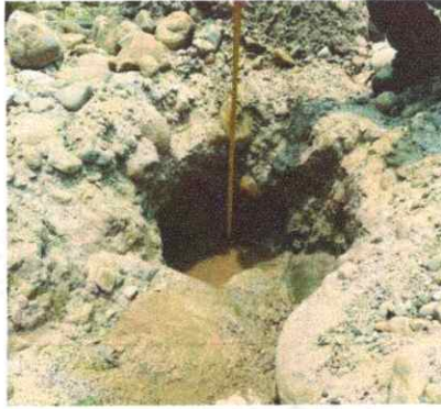
Apique M-1, abundante presencia de cantos y bloques en matriz arenosa limpia (SP)
