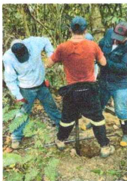
Locación área sondeo P-1 (K7+250). Recuperación de materiales que conforman la matriz de arena. Alta presencia de cantos y bloques de arenisca.
