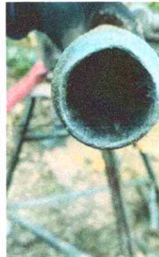
Locación área sondeo P-2 (K7+270). Recuperación de muestras por ensayo de penetración estándar (SPT) a profundidades de 0.6 – 1.2 m, 1.2 – 1.8 m y 1.8 – 2.4 m (rechazo de SPT a 2.55 m).
