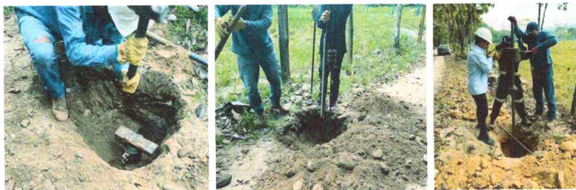
Fotografía 5. Recuperación de CBR y ensayos PDC y SPT
