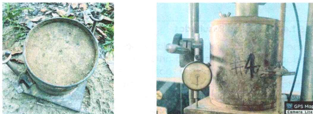
Fotografía 8. Ensayo de CBR en muestra de campo
