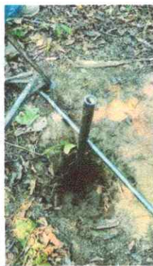
Locación área sondeo P-1 (K7+250). Recuperación de materiales que conforman la matriz de arena. Alta presencia de cantos y bloques de arenisca.
