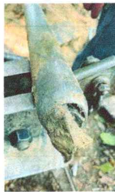
Locación área sondeo P-1 (K7+250). Recuperación de materiales que conforman la matriz de arena. Alta presencia de cantos y bloques de arenisca.
