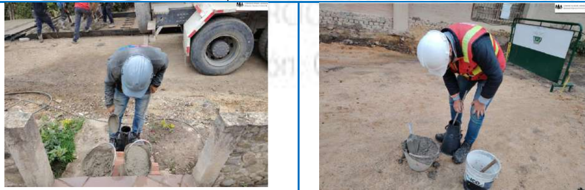
Foto # 2 Realización de ensayo de asentamiento "SLUMP" al concreto MR 5 MPA en conjunto con la interventoría
