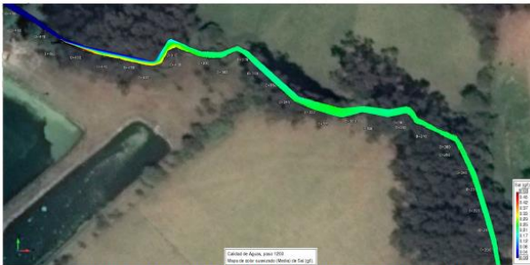
Figura 6 Cálculo de la longitud de mezcla para caudales máximos Fuente: Usuario. Informe de EAV (PP 41/67)
