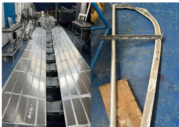
Foto No. 105 a 106 – bote 7 láminas de fondo y quilla.
