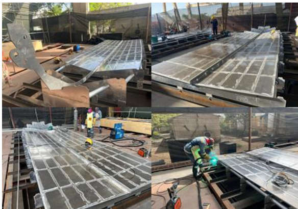
Foto No. 21 a 24 – bote 4 láminas de fondo quilla y barras
