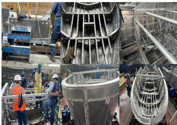
Foto No. 67 a 72 – Espejo, refuerzos de fondo, forro cuadernas y vagras
