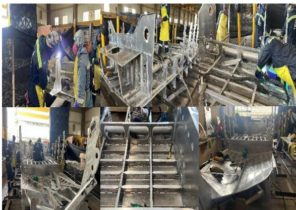
Foto No. 35 a 40 – bote 2 refuerzos, cuadernas vagras tuberías
