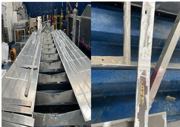
Foto No. 107 a 108 – bote 8 láminas de fondo y quilla.
