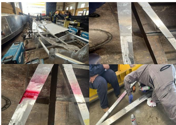
Foto No. 97 a 100 – bote 5 láminas de fondo, quilla y END
