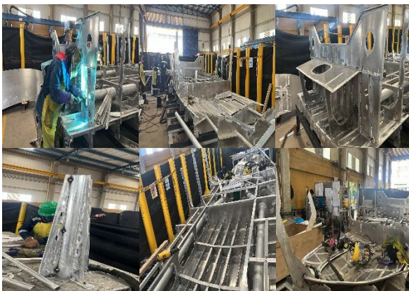
Foto No. 29 a 34 – bote 1 refuerzos, cuadernas vagras tuberías
