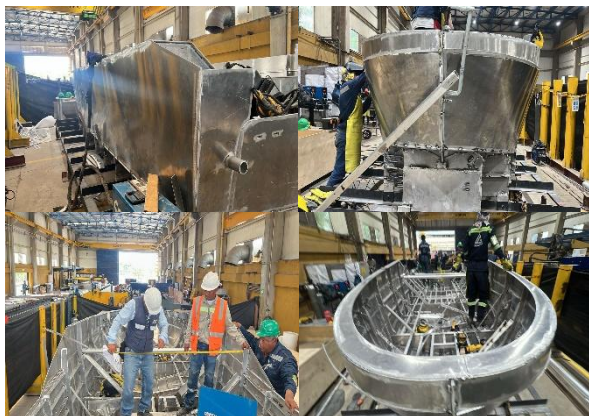
Foto No. 53 a 56 – bote 1 forro, refuerzos de fondo, cuadernas y vagras
