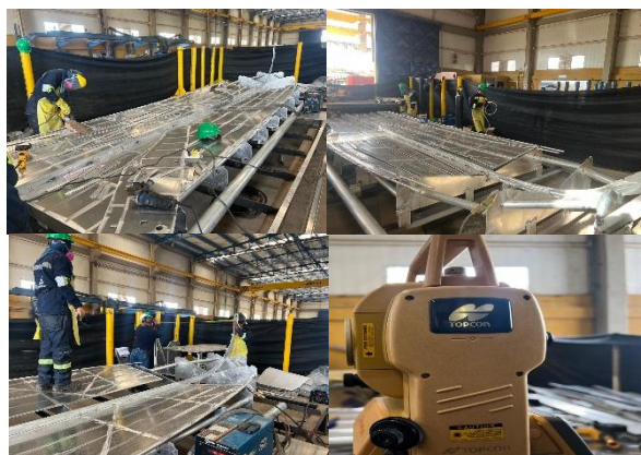
Foto No. 09 a 12 – bote 1 láminas de fondo quilla y barras.
