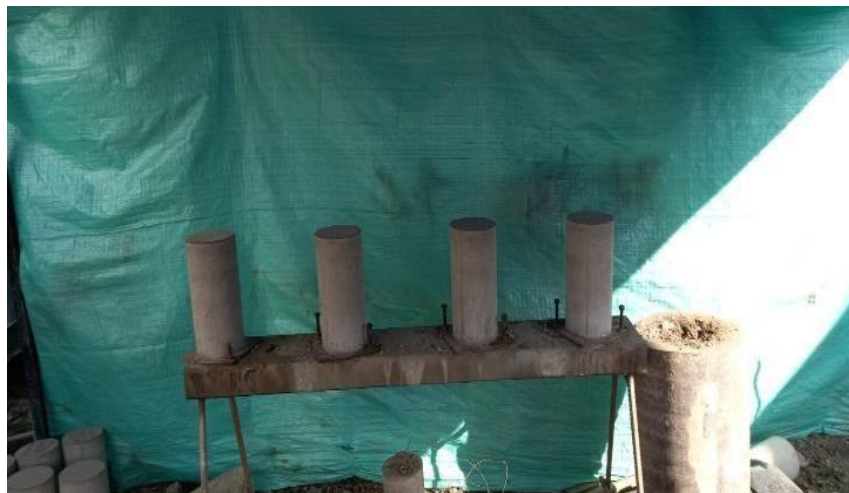
Ilustración 75. Toma de muestras concreto de Placas 3er nivel accesos No 2.
