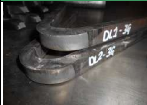
Figura 4. Doble de lado a probeta - DL1 - DL 2
