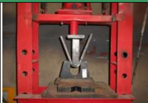
Figura 2. Doble z guiado de probeta de lado en matriz
