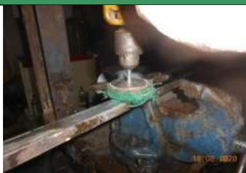
Figura 2. Preparación mecánica de probetas (paños)
