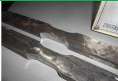
Figura 1. Probetas de tensión de sección reducida a fallar
