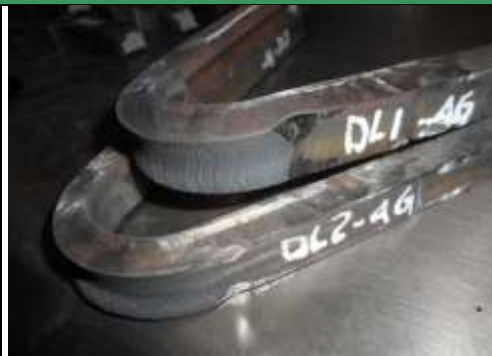
Figura 5. Dobleces de lado a probetas / DL 1 - DL 2
