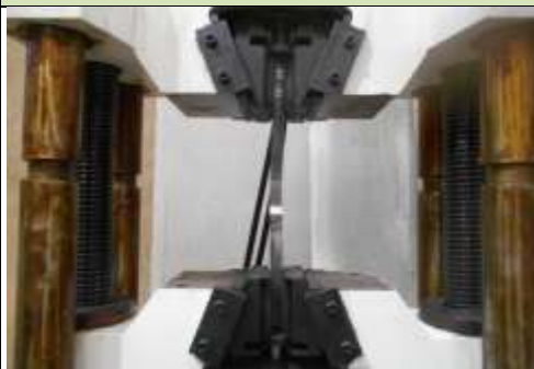
Figura 4. Rotura de probeta de T2
