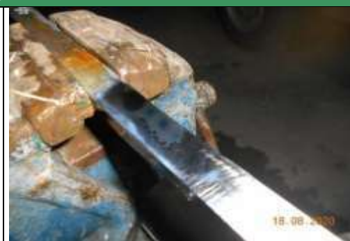
Figura 3. Preparación mecánica de probetas (paños)
