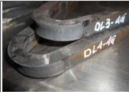
Figura 7. Dobleces de lado a probetas / DL 3 - DL 4
