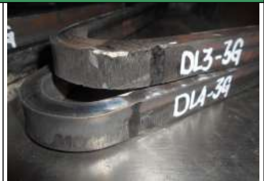
Figura 6. Doble de lado a probeta - DL3 - DL 4
