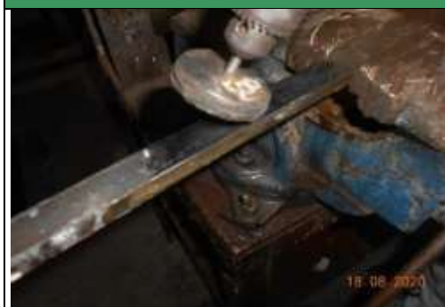
Figura 1. Preparación mecánica de probetas (lijas)
