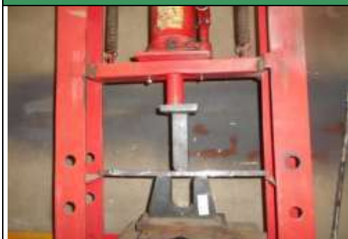
Figura 1. Ubicación de probeta de doblez en prensa hidráulica
