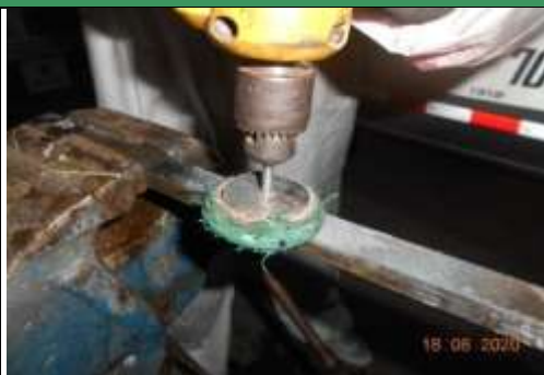
Figura 2. Preparación mecánica de probetas (pañes)
