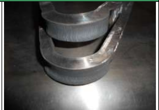
Figura 6. Dobleces de lado a probetas / DL 1 - DL 2
