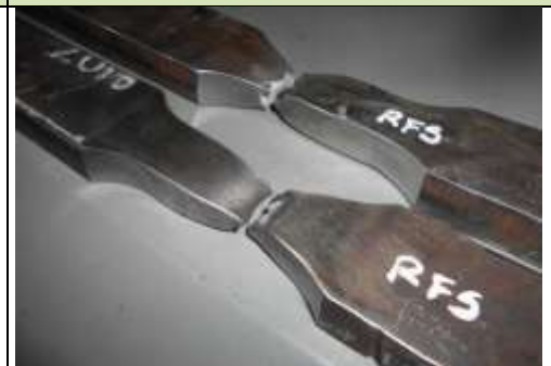
Figura 6. Rotura de probetas de T1 - T2
