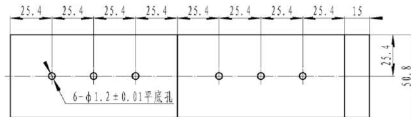
BLOQUE DE CALIBRACIÓN RELACIÓN 2:1 EN ALUMINIO 7075
