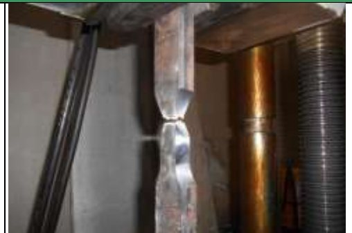
Figura 3. Rotura de probeta de T1
