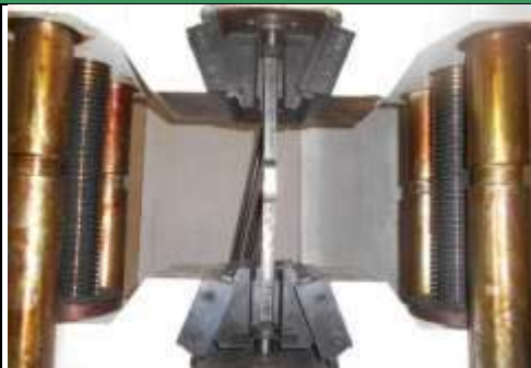
Figura 2. Rotura de probeta de T1
