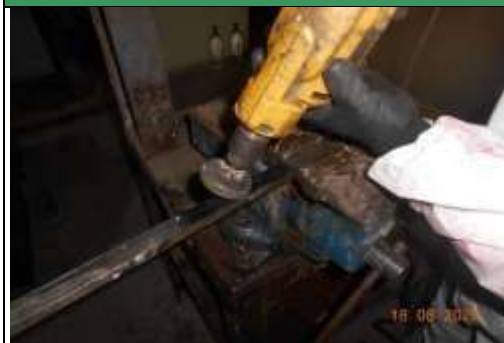
Figura 1. Preparación mecánica de probetas (lijas)
