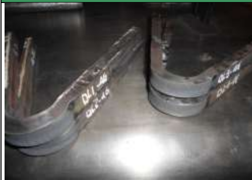
Figura 4. Probetas dobladas (4 dobleces de lado)
