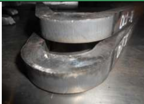
Figura 5. Doble de lado a probeta - DL1 - DL 2
