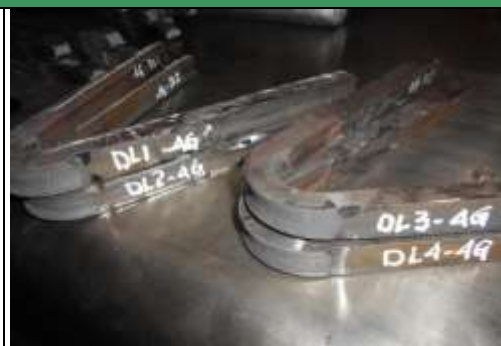
Figura 3. Probetas dobladas (4 dobleces de lado)
