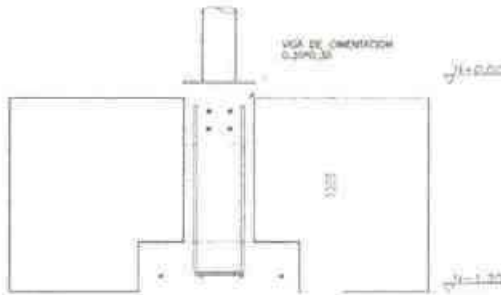
CORTE TÍPICO DE CIMENTACIÓN PASARELAS ESC. 1:20
