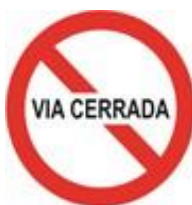
Imagen 7. Vía cerrada. Fuente: Manual de Señalización Vial 2015
