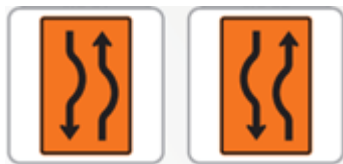
Figura 17. Cambio de alineamiento Fuente: Manual de Señalización Vial 2015.
