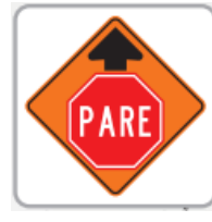
Figura 12. Proximidad a señal de pare Fuente: Manual de Señalización Vial 2015.
