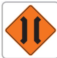
Figura 16. Puente angosto Fuente: Manual de Señalización Vial 2015.
