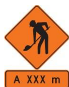
Figura 1. SPO-01 Trabajos en la Vía Fuente: Manual de Señalización Vial 2015
