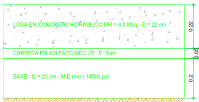
Ilustración 2 Sección típica de la estructura de pavimento.
