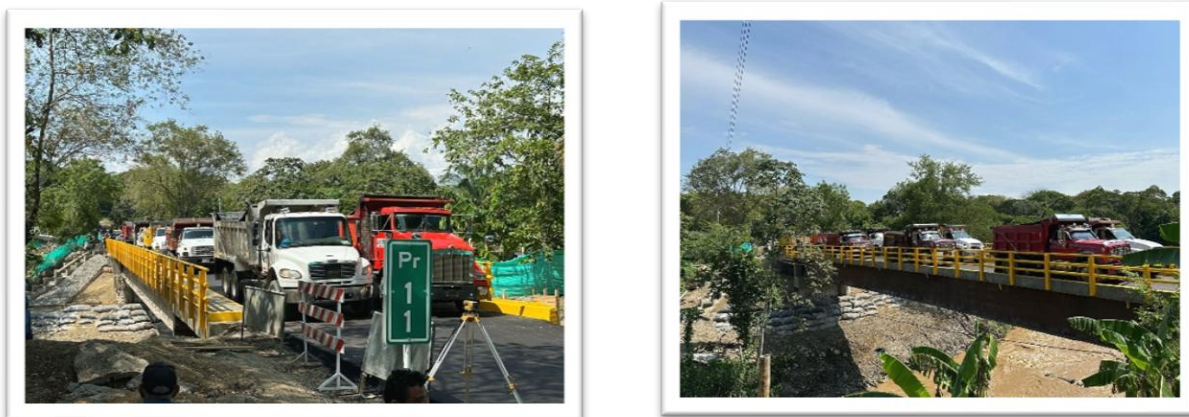
Figura No. 13. Prueba de carga interventoría y contratista.
