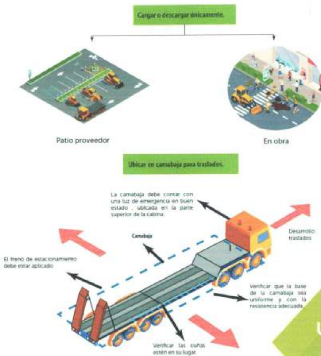
Imagen 22. Embarque de maquinaria de carga pesada.
