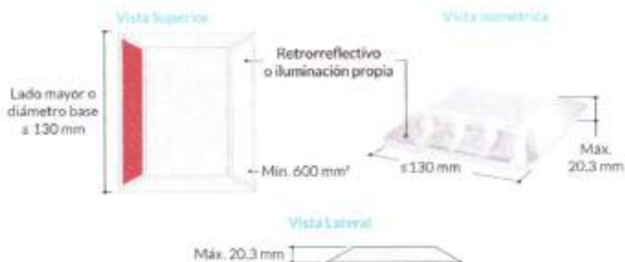
Imagen 11. Derramaciones elevadas típicas (tachas)
