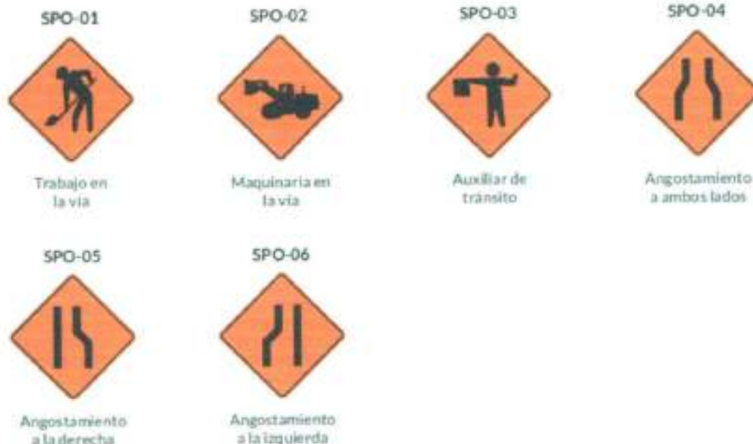
Imagen 3. Señales preventivas para obras.
