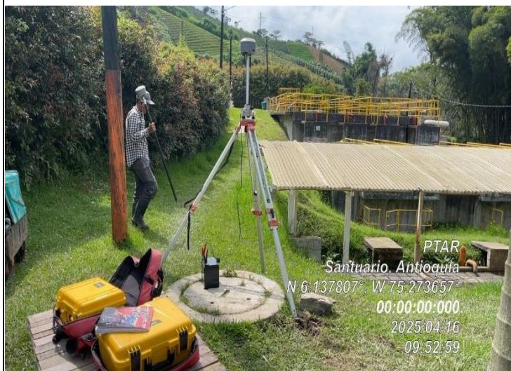
Fotografía 1. Levantamiento topográfico mediante sistema RTK para toma de cartera y cálculo de volúmenes de excavación y verificación de Cotas.
