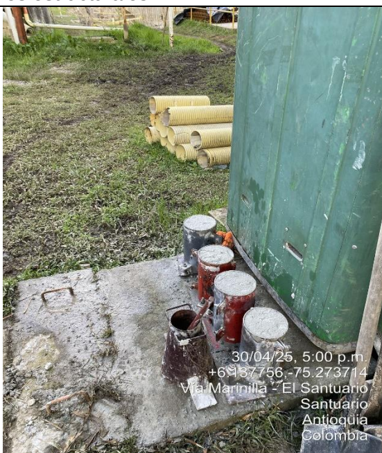
Fotografía 7. Toma de muestras de concreto para laboratorio de pilote E3.
