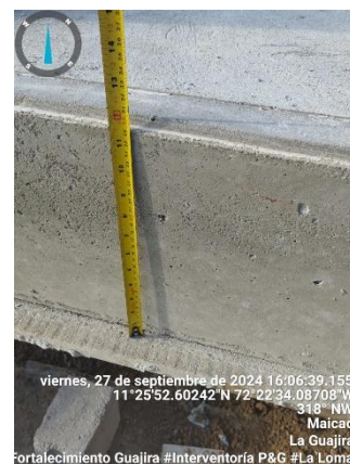
68. Se verifican dimensiones de viga aérea y placa de CASETA comunidad La Loma .
