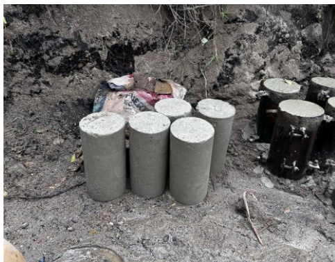
Ilustración 15. Toma de cilindros para fallar
