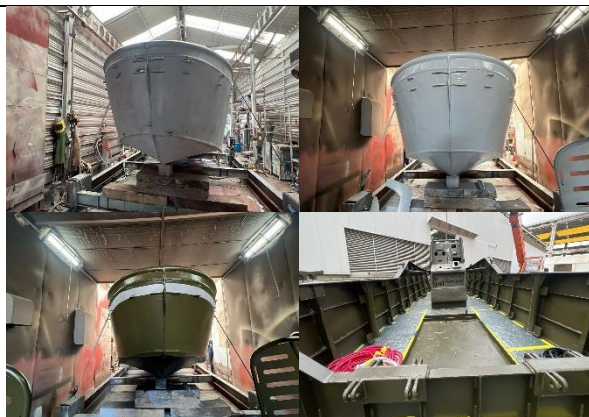
Foto No. 49 a 52 – Bote No. 2 Aplicación del esquema de pinturas
