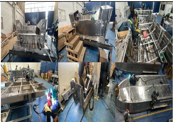
Foto No 113 a 118 –Bote No. 7 refuerzos, tanque, bancada y volteo.
