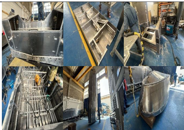
Foto No 113 a 118 –Bote No. 7 refuerzos, tanque, bancada y volteo.
