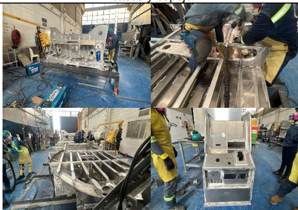
Foto No. 65 a 68 – Bote No. 6 refuerzos, forro del casco y espejo
