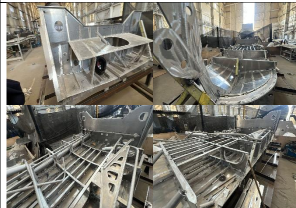
Foto No 161 a 164 –Bote No. 8 fondo, END y tanque de combustible
