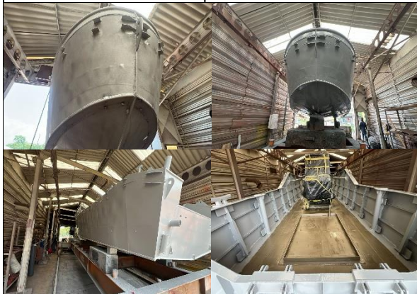
Foto No. 53 a 56 – Bote No. 3 Aplicación del esquema de pinturas
