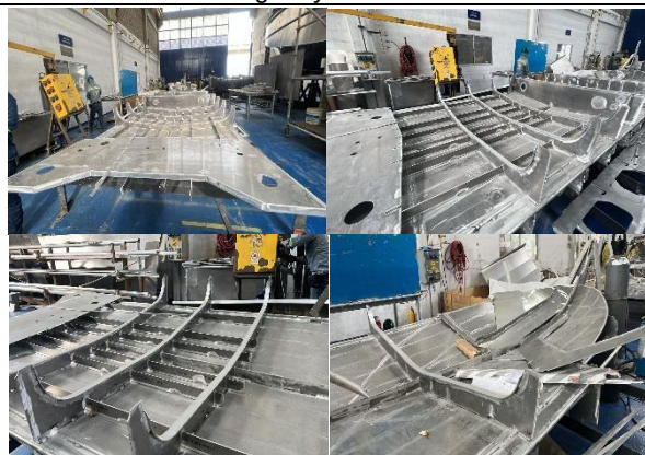
Foto No. 25 a 28 – Bote No. 6 refuerzos, cuadernas, vagras y tuberías
