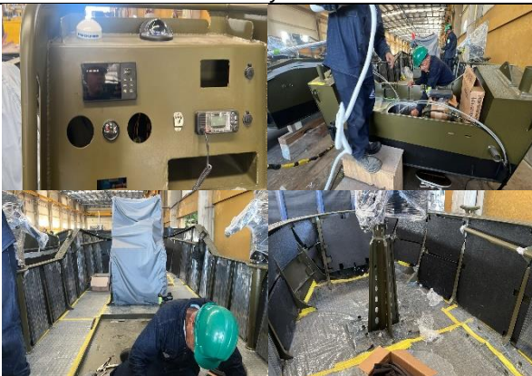
Foto No. 89 a 92 – Bote No. 2 Integración de equipos, balístico y afustes
