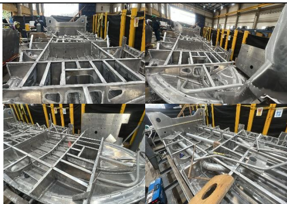
Foto No. 25 a 28 – Bote No. 6 refuerzos, cuadernas, vagras y tuberías
