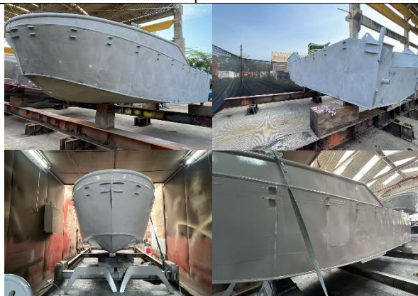
Foto No. 49 a 52 – Bote No. 2 Aplicación del esquema de pinturas
