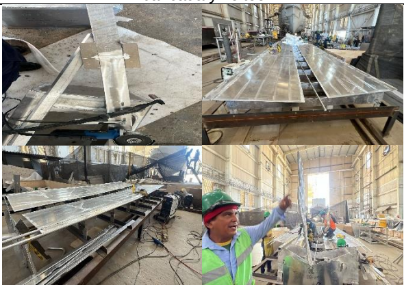
Foto No 119 a 124 –Bote No. 8 refuerzos, tanque, bancada y volteo
