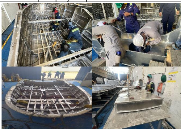
Foto No 153 a 156 –Bote No. 6 fondo, cubierta principal y tanque de combustible
