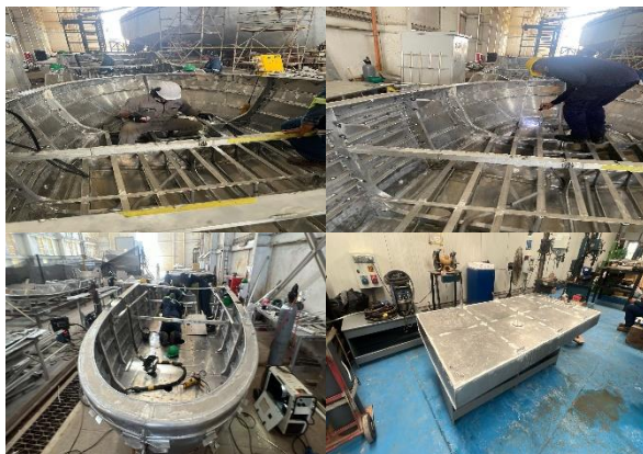
Foto No 148 a 152 –Bote No. 5 fondo, cubierta principal y tanque de combustible
