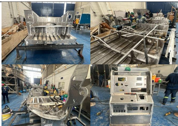
Foto No. 73 a 76 – Bote No. 8 refuerzos, cuadernas y consola
