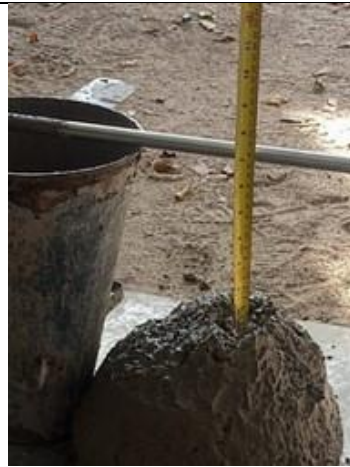
Fotografía No. 36 Ensayo de asentamiento
