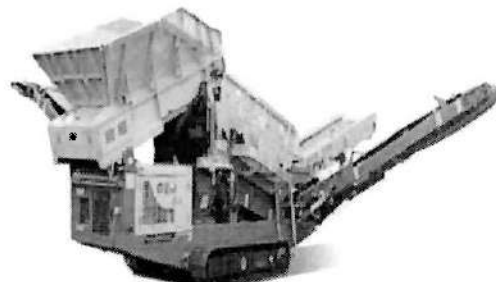
Ilustración No. 7. Zaranda de alta frecuencia. Planta de Tratamiento y Aprovechamiento de RCD – Cemex Colombia S.A.S.
