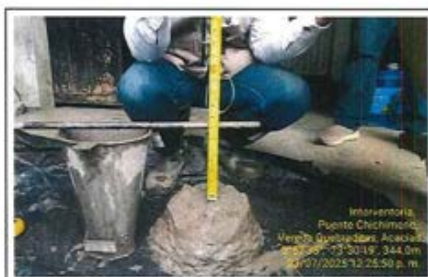
Fotografía 50: Control de Concreto mediante Ensayo de Asentamiento para viga cebazal margen Quebraditas.
