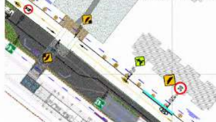
Imagen No. 12 Señalización para pompeyanos y resaltos parabólicos
