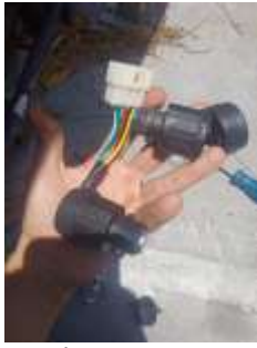
28 Julio 2025 04:31:48 pm Cambio de switch de encendido
