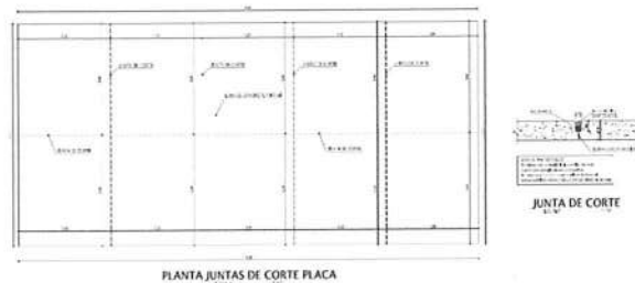
Ilustración No. 26 – vista de planta de rampa de la actividad de placa de piso en concreto de 3000 PSI e=0,10 mts, incluye corte de juntas y sello y Malla electrosoldada 2,35X6 15X15 4mm.
