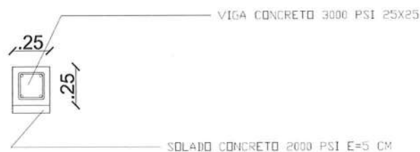
Ilustración No. 23 - detalle de viga en concreto y solado de la actividad de solado en concreto de limpieza 2000 P.S.I e=0.05 mts.
