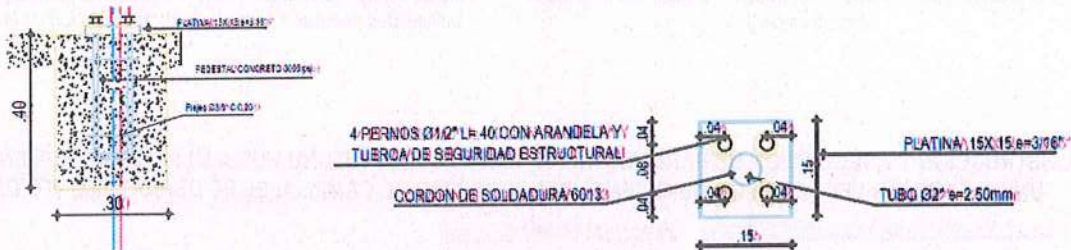
Ilustración No. 15 – detalles de la actividad de construcción de pedestales en concreto de 210 KG/CM2-3000 PSI de 30*30 altura 40 cm, para soportar barandas perimetrales. Incluye (2 pernos \phi 1/2" L=0.40 c/u, con arandela, tuerca y todas las actividades necesarias para correcta ejecución de la actividad.
