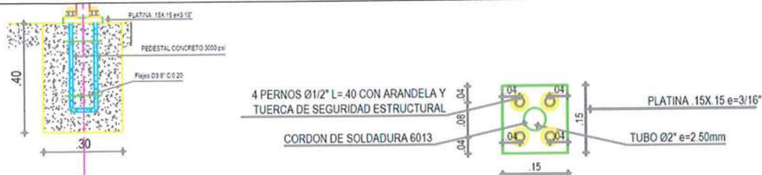
Ilustración No. 30 – detalles de la actividad de construcción de pedestales en concreto de 210 KG/CM2-3000 PSI de 30*30 altura 40 cm, para soportar barandas perimetrales. Incluye (2 pernos \phi 1/2" L=0.40 c/u, con arandela, tuerca y todas las actividades necesarias para correcta ejecución de la actividad.
