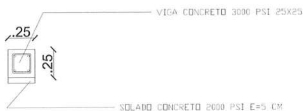
Ilustración No. 8 – detalle de viga en concreto y solado de la actividad de solado en concreto de limpieza 2000 P.S.I e=0.05 mts.
