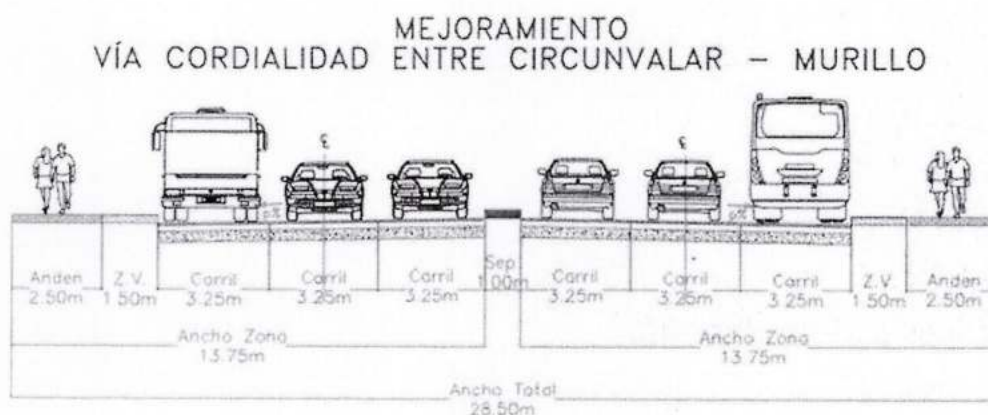
Sección transversal típica entre Cordialidad y Murillo
