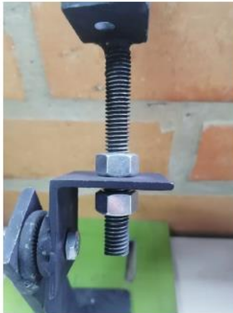
Foto 20. Elemento de fijación y elemento de extensión o graduación
