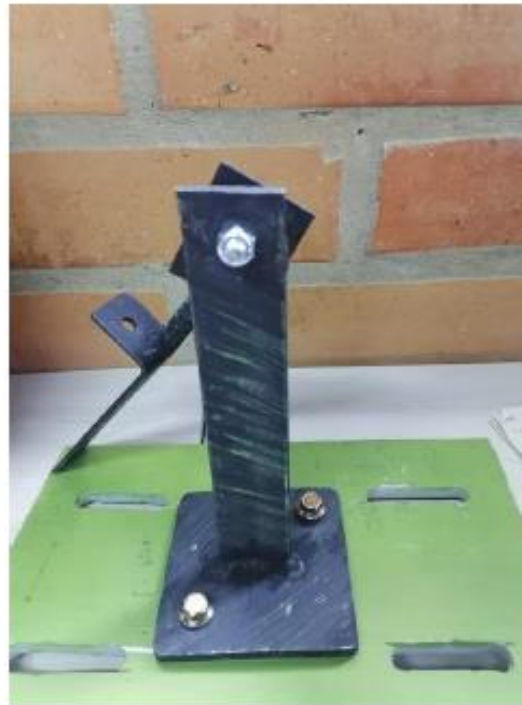
Foto 18. Platina en acero anclada a la base en madera plástica y brazo soldado a 90°
