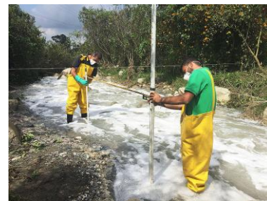
Figura 17. Uso y aplicación del aforo por método del molinete
