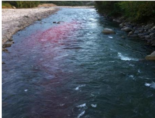
Figura 22. Ensayo con trazadores en el río Cravo Sur en el sector de La Cabaña, Yopal, Casanare. Fuente: Archivo Empresa Fluvia, 2014.
