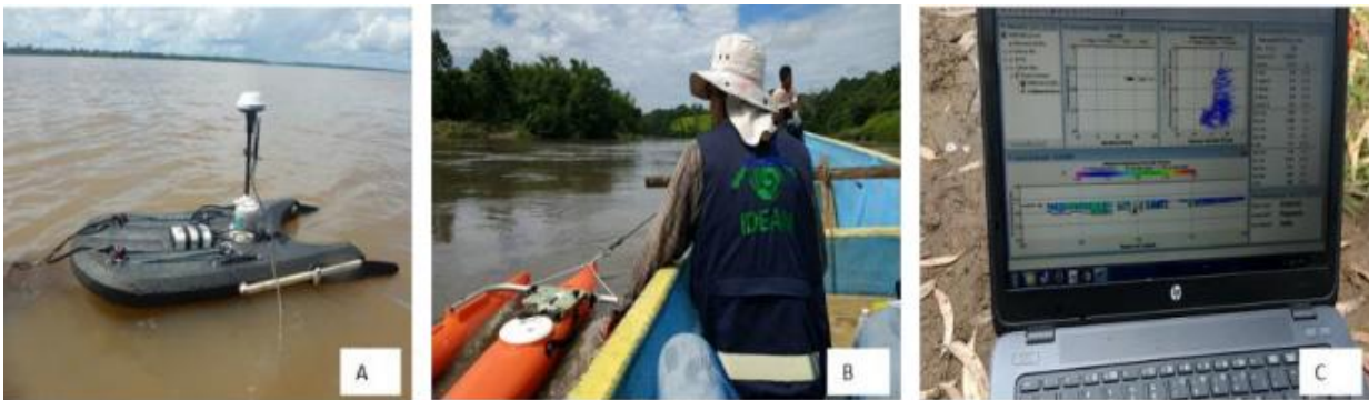
Figura 19. Medición de caudal en el equipo ADCP. A. río Amazonas, B. río San Juan, C. Transmisión del ADCP al computador, con información de: perfil transversal, caudal parcial, profundidad, distancia, velocidad del agua, velocidad de la barca. Estación Rumichaca, río Guátara. Fuente. Áreas operativas 11 y 7 IDEAM, 2017.
