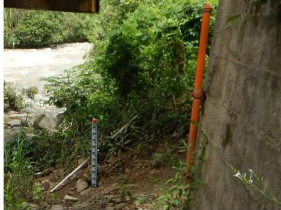
Figura 14. Maxímetro. Estación Puente Venado, río Venado. Fuente. Área Operativa 7- IDEAM 2017.
