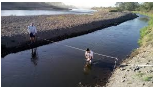
Figura 17. Uso y aplicación del aforo por método del molinete
