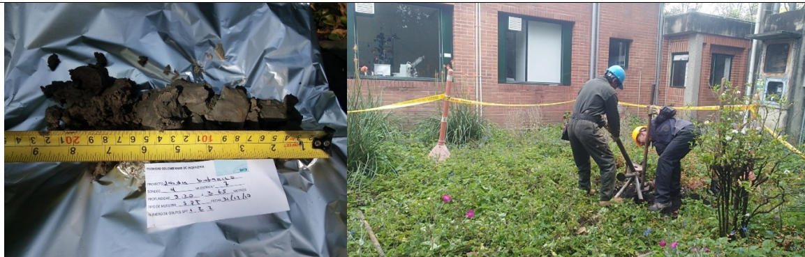
Foto 4. Ejecución de sondeos S4 y S5 en subdirección científica.
