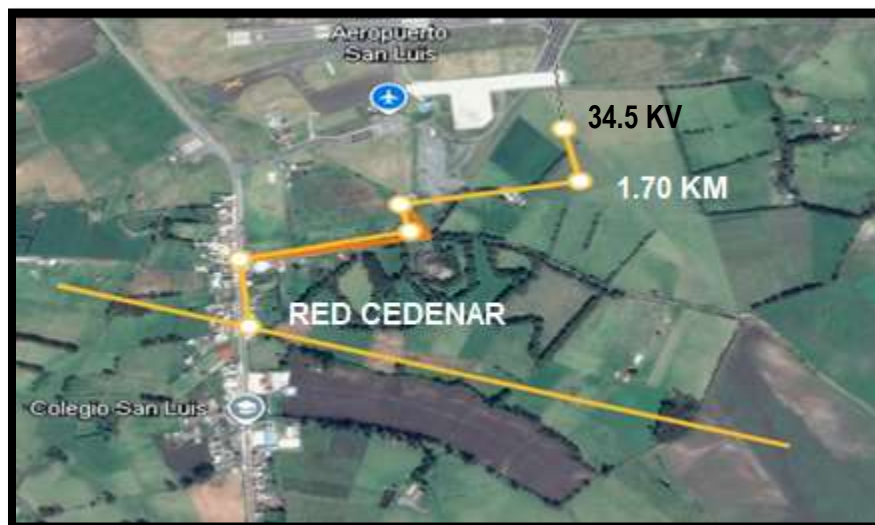
Figura 15. Acometida eléctrica de Ipiales al Aeropuerto San Luis
